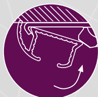
Eenvoudig te monteren: inklikken-positioneren-vastzetten
